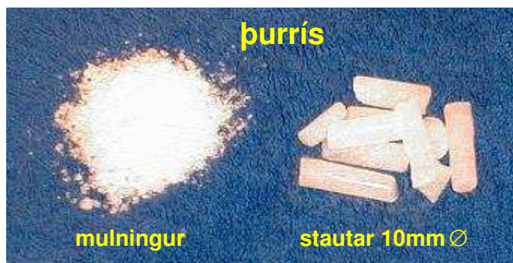
Mynd 1: Þurrís. Hægra megin eru ísstautar 10mm í þvermál og 10 til 30mm langir, vinstra megin er íssalli með kornastærð 1 til 3mm í þvermál.
